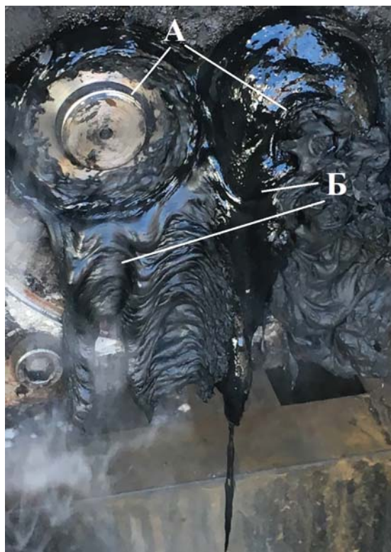
Рис. 1. Выход битумоподобного продукта в процессе переработки отходов синтетических полимеров: А – шнеки экструдера; Б – битумоподобный продукт
